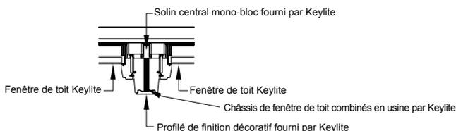
DÉTAIL DU JOINT DE FENÊTRE DE TOIT FRX
