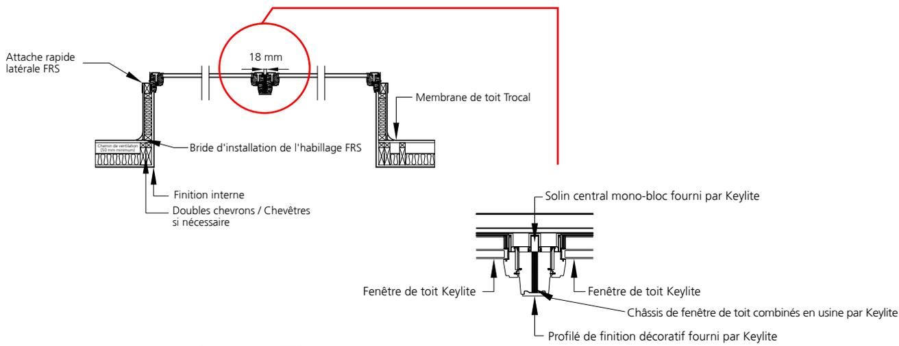
DÉTAIL DU JOINT DE FENÊTRE DE TOIT FRX
